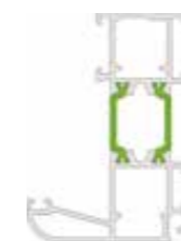
Dormant pour pose en tunnel sans aile Février 2018
