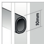
Petit bois intégré dans le vitrage 10x8mm couleur plomb
