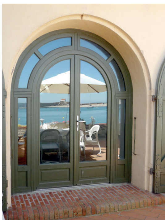
Porte fenêtre 2 vantaux avec ensemble clé aluminium brossé, traverses intermédiaires, panneaux de soubassement à plate bande, petits bois en applique, seuil handicapé en aluminium.
