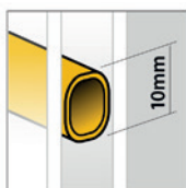
Petit bois intégré dans le vitrage 10x8mm couleur laiton
